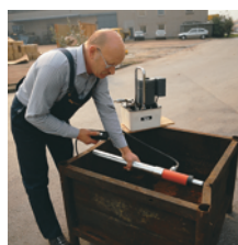
矫正包装箱，使用 YS-10/150型液压缸， AYS-160型延长管， AYS-103底盘和 PY-04/2/5/2M电动泵
