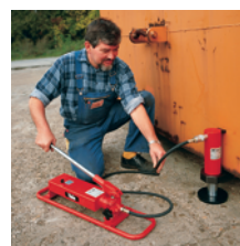
顶起包装箱，使用 YS-23/160型液压缸， AYS-23型提升爪， AYS-232型活塞底盘， HPS-2/2型二级手动泵， HPB-2型手动泵底盘
